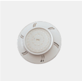
ONDERWATERLAMP LED Ø 10 cm, 850 lumen, 12V met doorvoerstuk voor de houten structuur; Elektrische koffer met transfo noodzakelijk.
